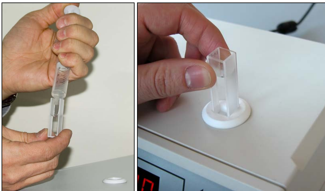
Рис.3. Установка кюветы с пробой раствора.
